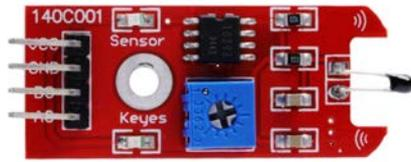
熱敏電阻(NTC)溫度感測器模組可以和 Arduino 控制板上的數位 13 接埠，以模組上的 LED 搭建製作出熱敏電阻(NTC)溫度感測器模組提示燈。
