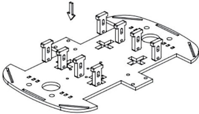
安裝步驟：撕下壓克力黃色保護膜後，將緊固件插入底盤。
