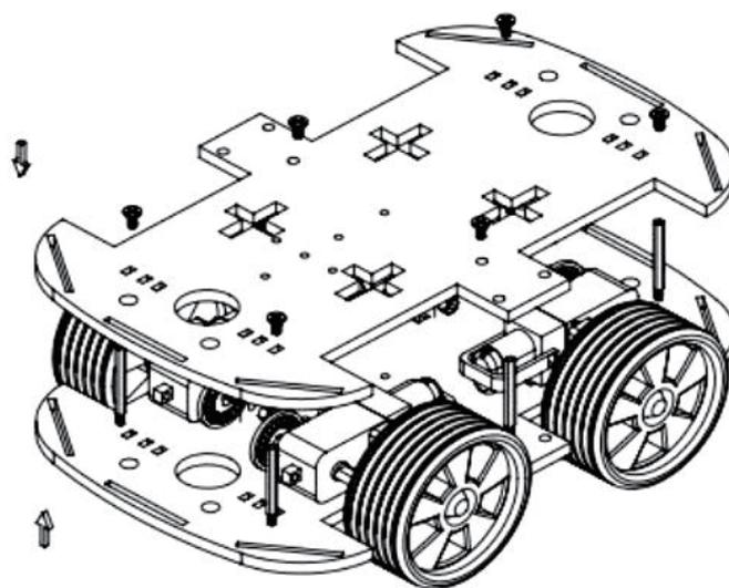
Step5：插入銅柱，從下方插入螺絲，從上方鎖緊，安裝完成。
