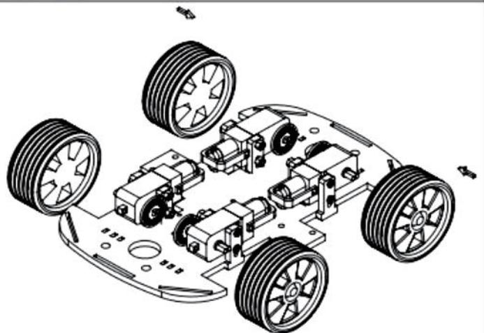
Setp4：握緊並插入電機（保護緊固件）到車輪。
