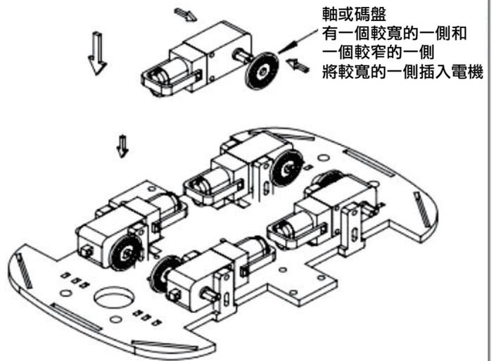
Step2：安裝碼輪，將電機固定在底盤上
