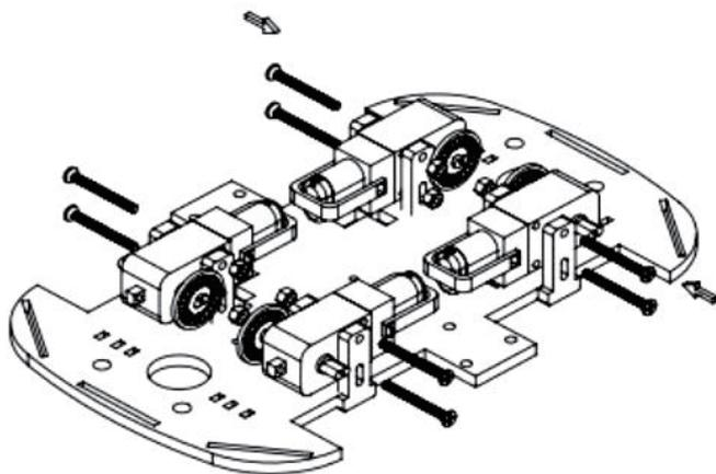
Setp3：將電機固定到底盤上，然後安裝並鎖緊螺絲。
