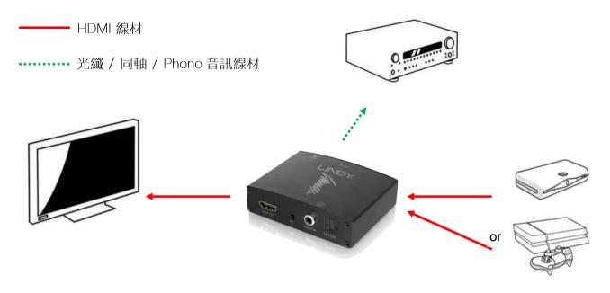
請先確認所有裝置皆已關閉電源·按上圖標示方式連接·並將所附的 USB 轉 DC 電源線連接上影音設備上的 USB 埠或是額外的 USB 充電器·並開啟所有裝置設備的電源。
