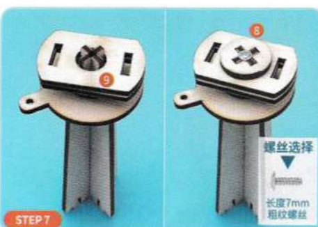
● 把两块⑨号板对齐孔位安装在⑧号板上。然后用一颗7mm螺丝把一块⑨号板安装在⑧号板上。
