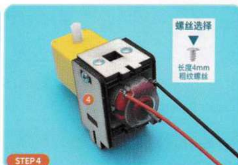
● 先把②、③号板卡住电机，然后用4mm螺丝把两块④号板分别安装在②、③号板上。注意：①、④号板的朝向。
