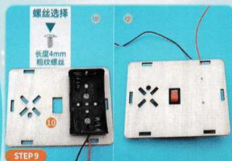
● 步骤①：用4mm螺丝把电池盒安装在⑩号板上。步骤②：把船形开关安装在⑩号板上。
