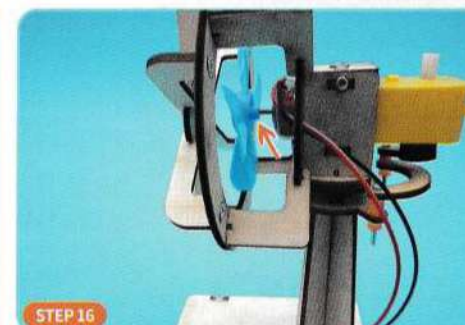
● 把风机扇叶安装在电机轴上。
