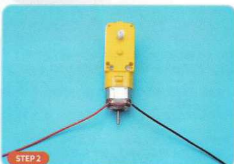
● 把两根20cm红黑导线连接在TT电机金属片的两端。
