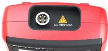
輸入埠為航空插頭，最大允許輸入電壓為DC 100V，禁止輸入交流電壓。
