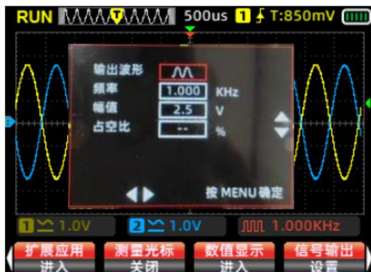
備註：當前模式下信號輸出波形為脈衝波、正弦波和鋸齒波時，示波器最大測量時基只能到100us；若恢復時基則將信號輸出設為方波。
